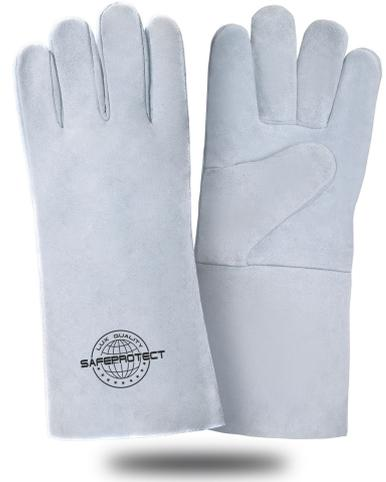
Краги КАРЕЛИЯ спилковые для защиты от механических воздействий (истирание, прокол, порез, разрыв) и повышенных температур (от теплового излучения, конвективной теплоты, от искр и брызг расплавленного металла, от кратковременного воздействия открытого пламени, контакта с нагретыми поверхностями до +100\*С). Спиллок КРС, сорт АВ (1,4+/- 0,2 мм), шлифованный, серого цвета, толщина и выделка спилка обеспечивает сохранение мягкости в течение длительного времени. .
