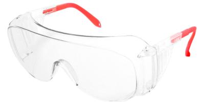
Универсальные очки с панорамным защитным стеклом увеличенного размера из бесцветного поликарбоната с твердым покрытием на наружной стороне и с незапотевающим покрытием на внутренней, обращенной к глазу, стороне.
