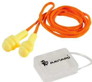
Противошумные вкладыши предназначены для защиты органа слуха от воздействия интенсивных промышленных шумов. Силиконовые многоразовые противошумные вкладыши КОМФОРТ Л со шнуром имеют 3-х ярусную купольную конструкцию, подходящую для слуховых каналов различного размера. В производстве этих вкладышей используется пищевой силикагель, который характеризуется экологичностью и гипоаллергенностью. Вкладыши изготовленные из этого материала не деформируются, не ломаются, их можно использовать многократно.
